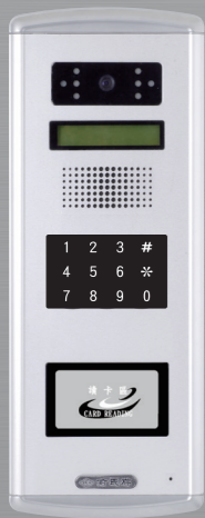
DFC1-MLT 嵌入式彩色攝影門口機 外觀尺寸：420X160X15mm(嵌入25mm)
